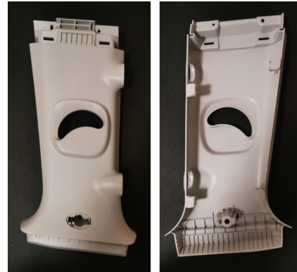
图6 汽车B柱上饰板试模样品
